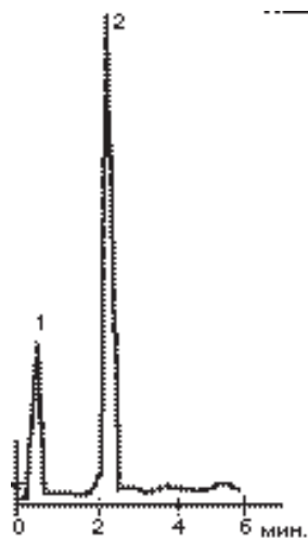
Рис. I.46. Определение формальдегида в воздухе в виде производного с уротропином [99]. Условия в тексте. 1 — растворитель; 2 — гексаметиленetetрамин.
