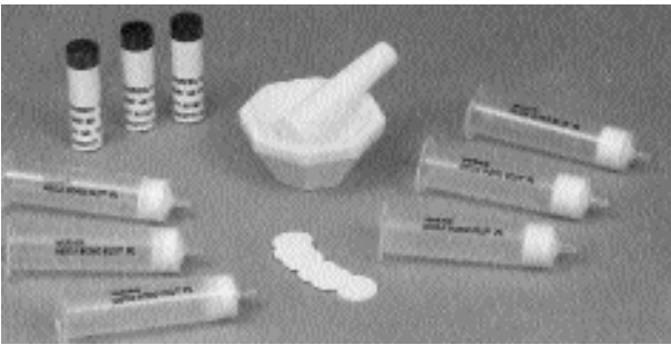
Рис. V.7. Комплект оборудования для твердофазной дисперсии (экстракции) матрицы пищевых продуктов [34]. Пояснения в тексте.
