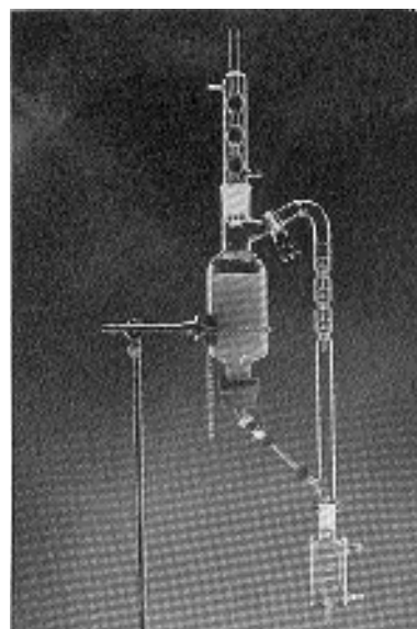
Рис. II.7. Непрерывный жидкостно-жидкостный экстрактор с колбой Кудерна-Даниш [1, 11] — А и общий вид экстрактора — В: 1 — обратный холодильник; 2 — колонка Снайдера; 3 — колба Кудерна-Даниш; 4 — приемник; 5 — нагреватель.
