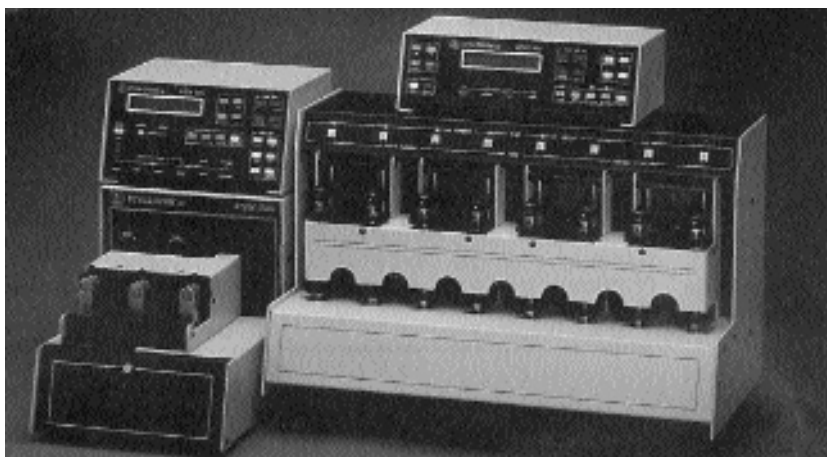
Рис. III.3. Автоматический термодесорбер для анализа газовой выделений почвы методом газовой хроматографии [21]. Пояснения в тексте.
