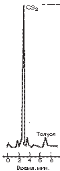
Рис. 1.38. Хроматограмма воздуха, загрязненного сероуглеродом в производстве вискозы [240], полученная на капиллярной колонке с химически связанным силиконом OV — 1701 (толщина пленки 0,1 мкм) при 85°C с ЭЗД.
