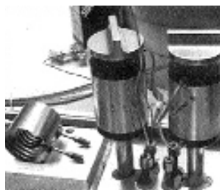
Рис. 1.75. Термодесорбционное устройство (концентратор), вмонтированное в газовый хроматограф фирмы Вариан [33].
